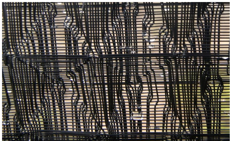
Figure 5. Detalle de malla KIMRE, estructura piramidal fabricada por Massachusetts Institute of Technology. Foto de la Fundación Un alto en el Desierto, 2018
